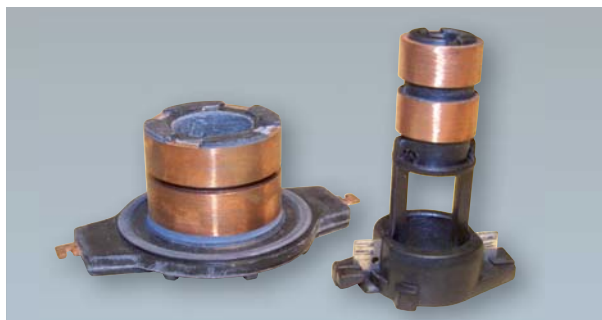
4 Snímací kroužky bývají často příčinou poruchy. Jejich výměnou lze rovněž ušetřit značné náklady na opravu.
