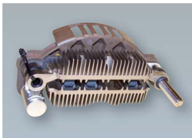
2 Celkové výměně alternátoru zabrání pouhá výměna poškozeného diodového bloku.
